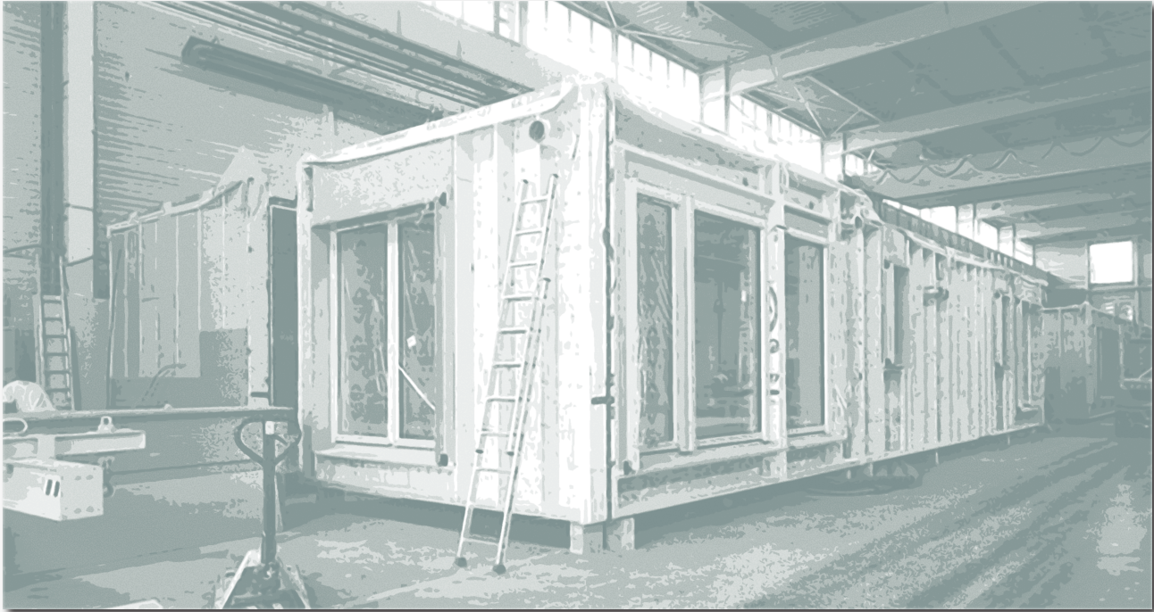
Les éléments de plusieurs tonnes sont déplacés par le pont roulant de cette ancienne usine automobile
